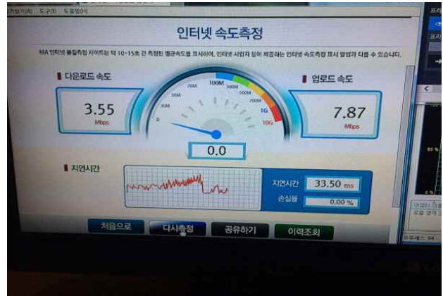
그림 4. 가시광 무선통신 데이터 전송속도 측정
