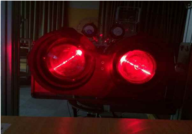
그림 2. 프레넬 렌즈를 이용한 송신부, 수신부
